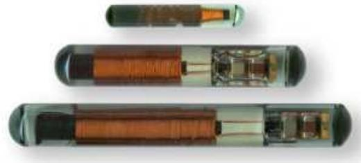
Abb. 4: Beispiele von HDX-PIT-Tags unterschiedlicher Grösse
