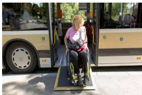
banchina con altezza di 16 cm affinché la pendenza della rampa retrattile risulti \leq 12\% (max 18% in caso di assistenza da parte del personale)
