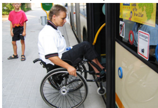
banchina con bordo speciale, altezza \geq 22 cm, luce massima residua: \Delta h \leq 5 cm, \Delta b \leq 7,5 cm
