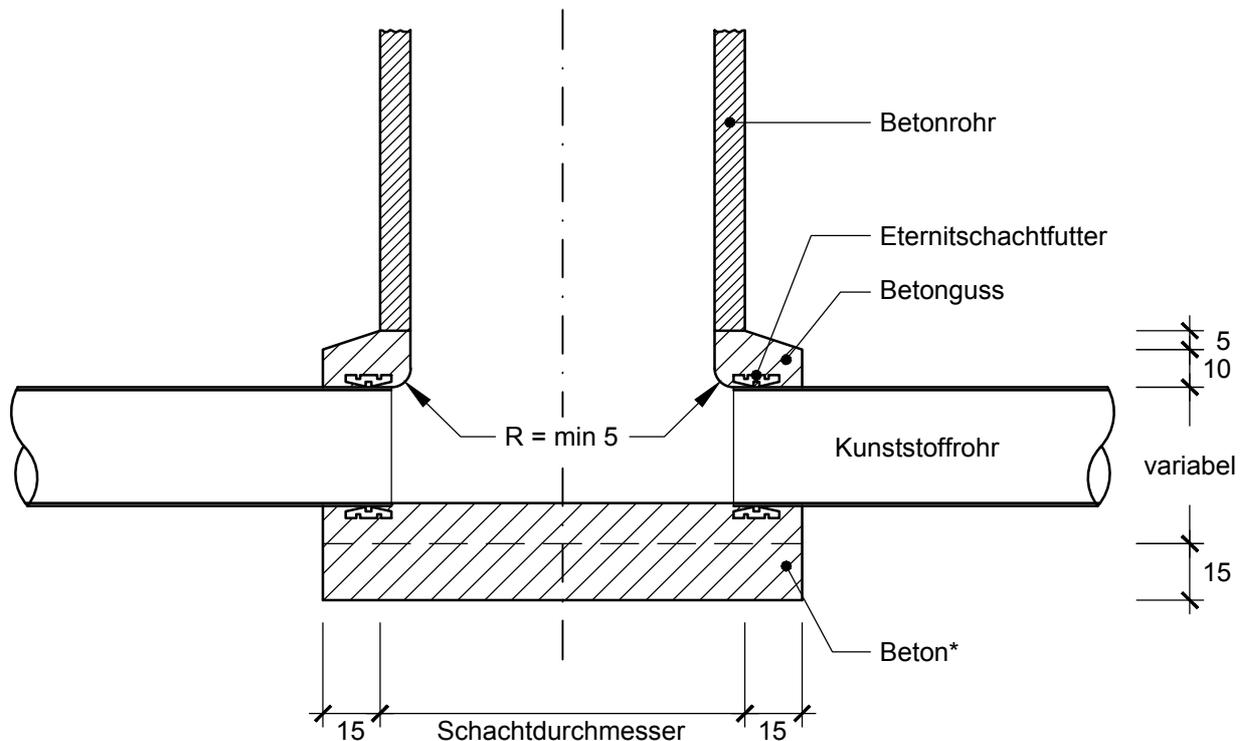
\*Beton: C 25/30, XF2 (CH), Dmax 32, CI 0.10 (SN EN 206-1)
