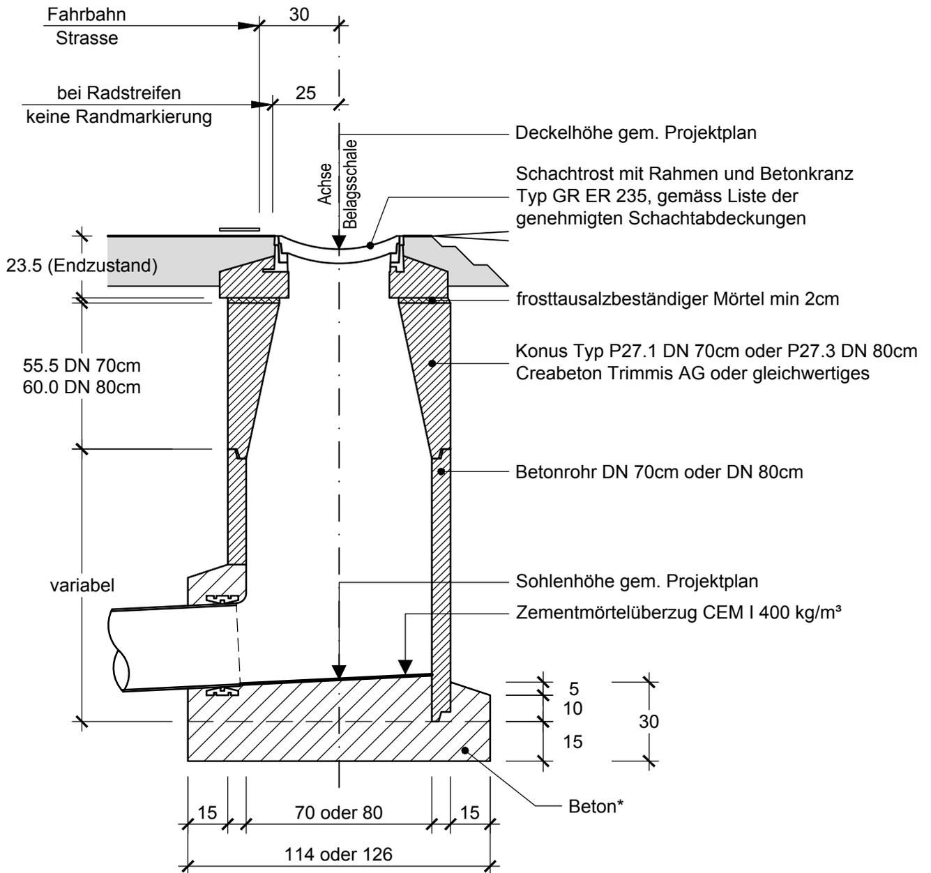
\*Beton: C 25/30, XF2 (CH), Dmax 32, CI 0.10 (SN EN 206-1)
