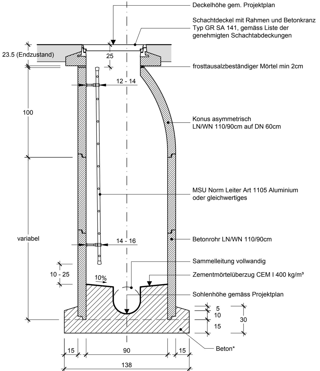
\*Beton: C 25/30, XF2 (CH), Dmax 32, CI 0.10 (SN EN 206-1)
