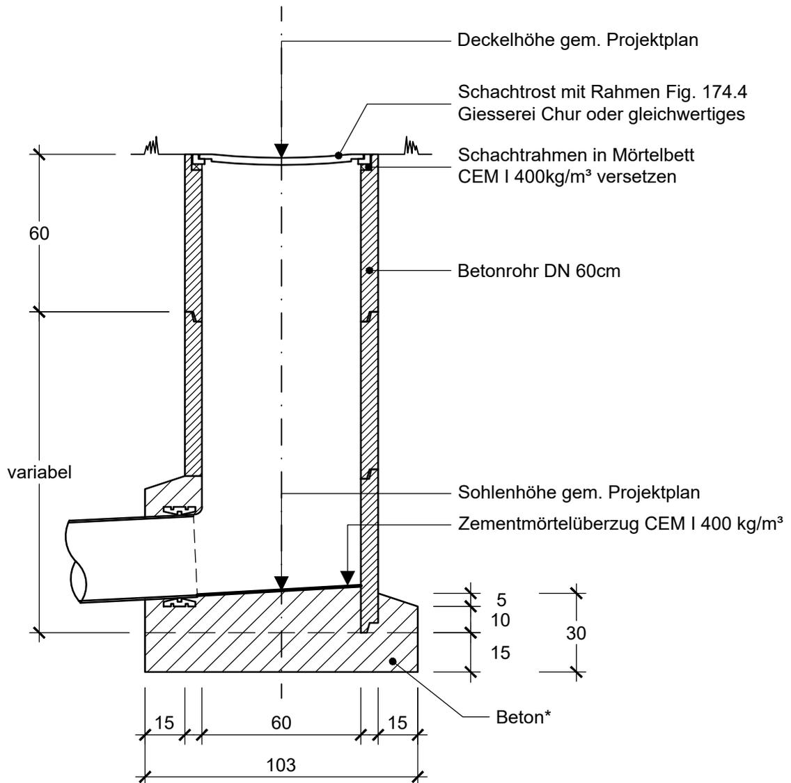
\*Beton: C 25/30, XF2 (CH), Dmax 32, CI 0.10 (SN EN 206-1)
