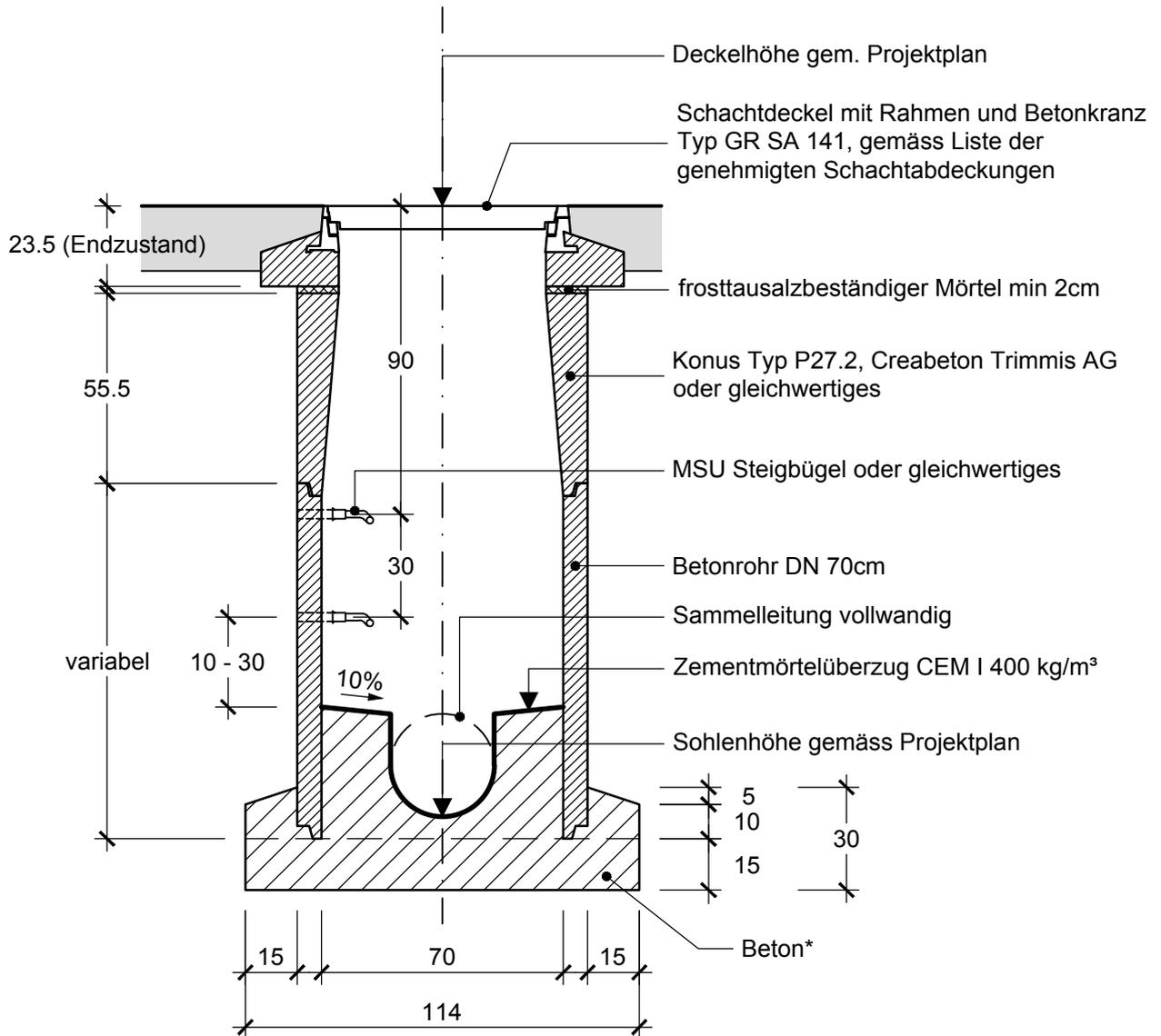
Bei Durchlaufrinnen bis NW 300 oder mit Seitenanschluss bis NW 250
