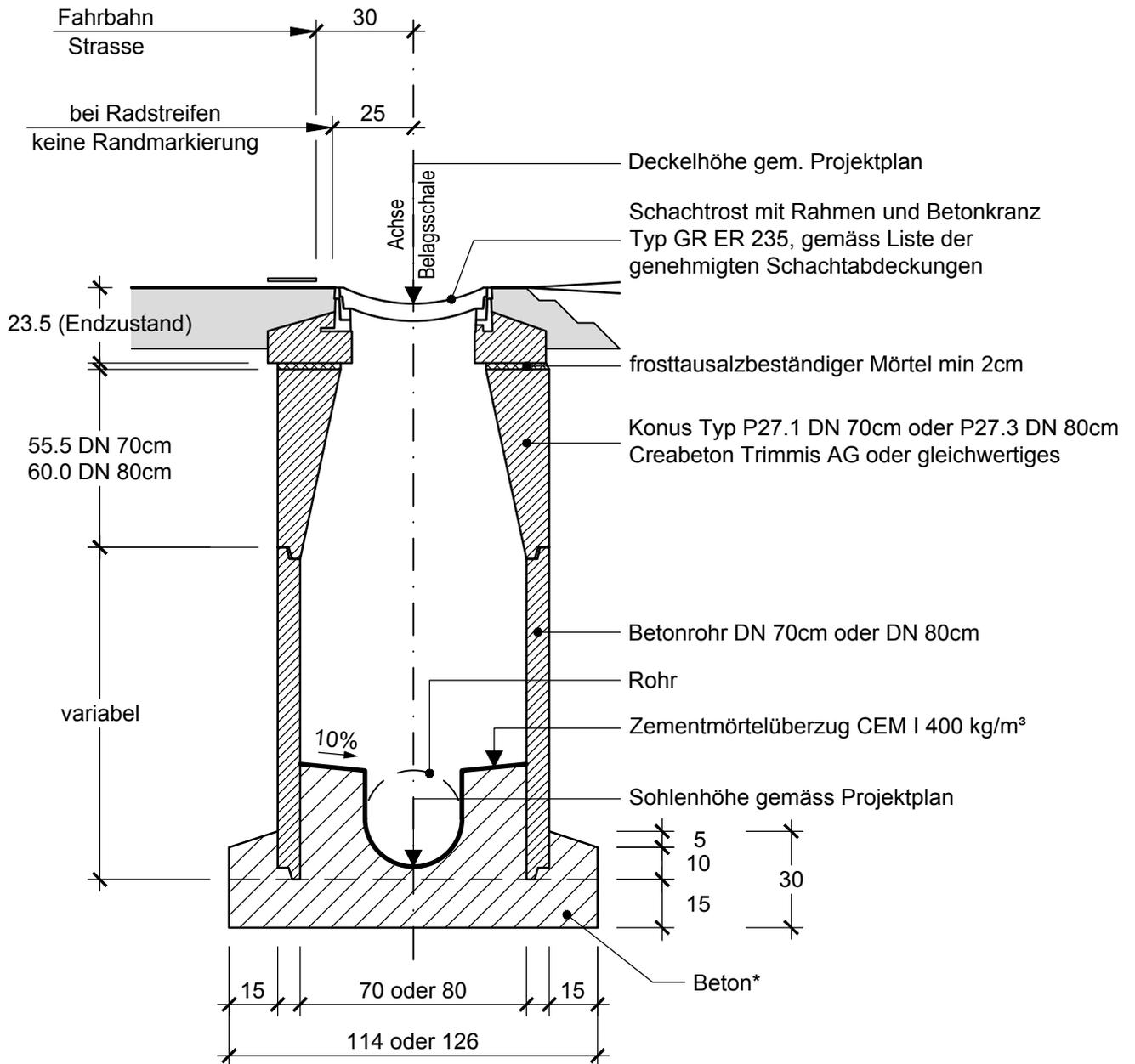
Bei Durchlaufrinnen bis NW 300 oder mit Seitenanschluss bis NW 250
