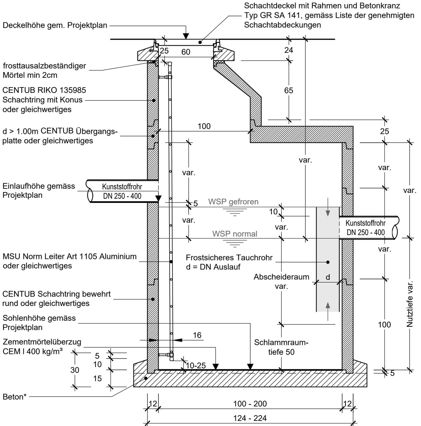
\*Beton: C 25/30, XF2 (CH),  $D_{\text{max}} 32$ , CI 0.10 (SN EN 206-1)
