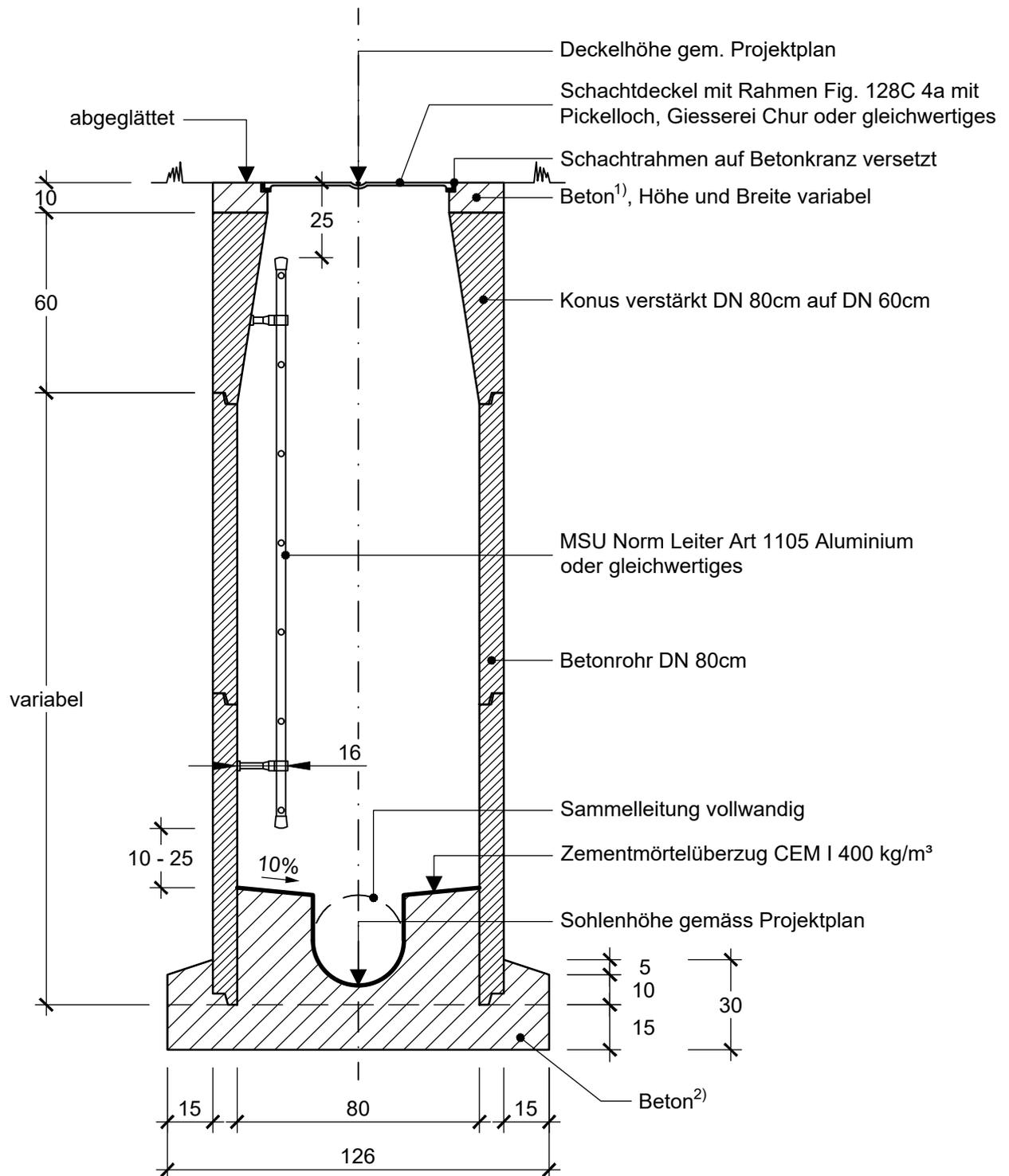
Bei Durchlaufrinnen bis NW 300 oder mit Seitenanschluss bis NW 250
