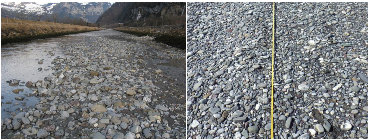
Bild 4: Sohlsubstrat im kanalisierten Escherkanal in der Aufweitung Chli Gäsitschachen bei der Trockenlegung vor (links, 24.02.2012) und nach der Realisierung der Aufweitung (rechts, 01.04.2013).
