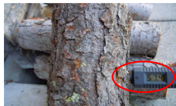
Figuren a und b: je gleiche Holzstücke; unterschiedliche Feuchtigkeit bei Rinde oder Stirnholz
