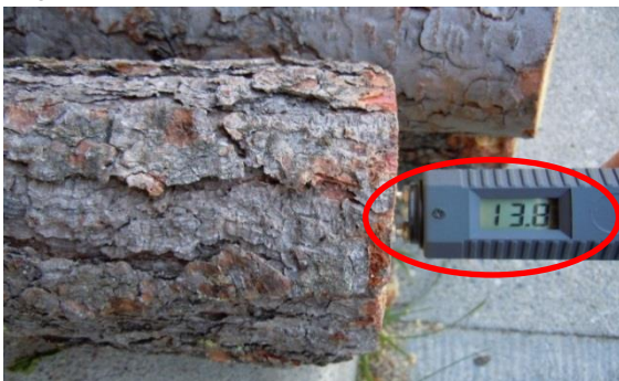
Figuren a und b: je gleiche Holzstücke; unterschiedliche Feuchtigkeit bei Rinde oder Stirnholz
