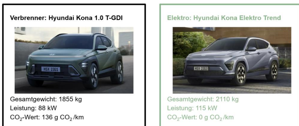
Abbildung 14. Hyundai Kona mit Verbrennungsmotor (links) und als Modell mit elektrischem Antrieb (rechts). Das Modell mit elektrischem Antrieb weist ein Mehrgewicht und eine Mehrleistung gegenüber dem Verbrennungsmodell auf. Quelle: https://www.adac.de
